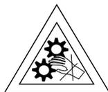
Gefährdung durch mechanische Verletzungsgefahr
